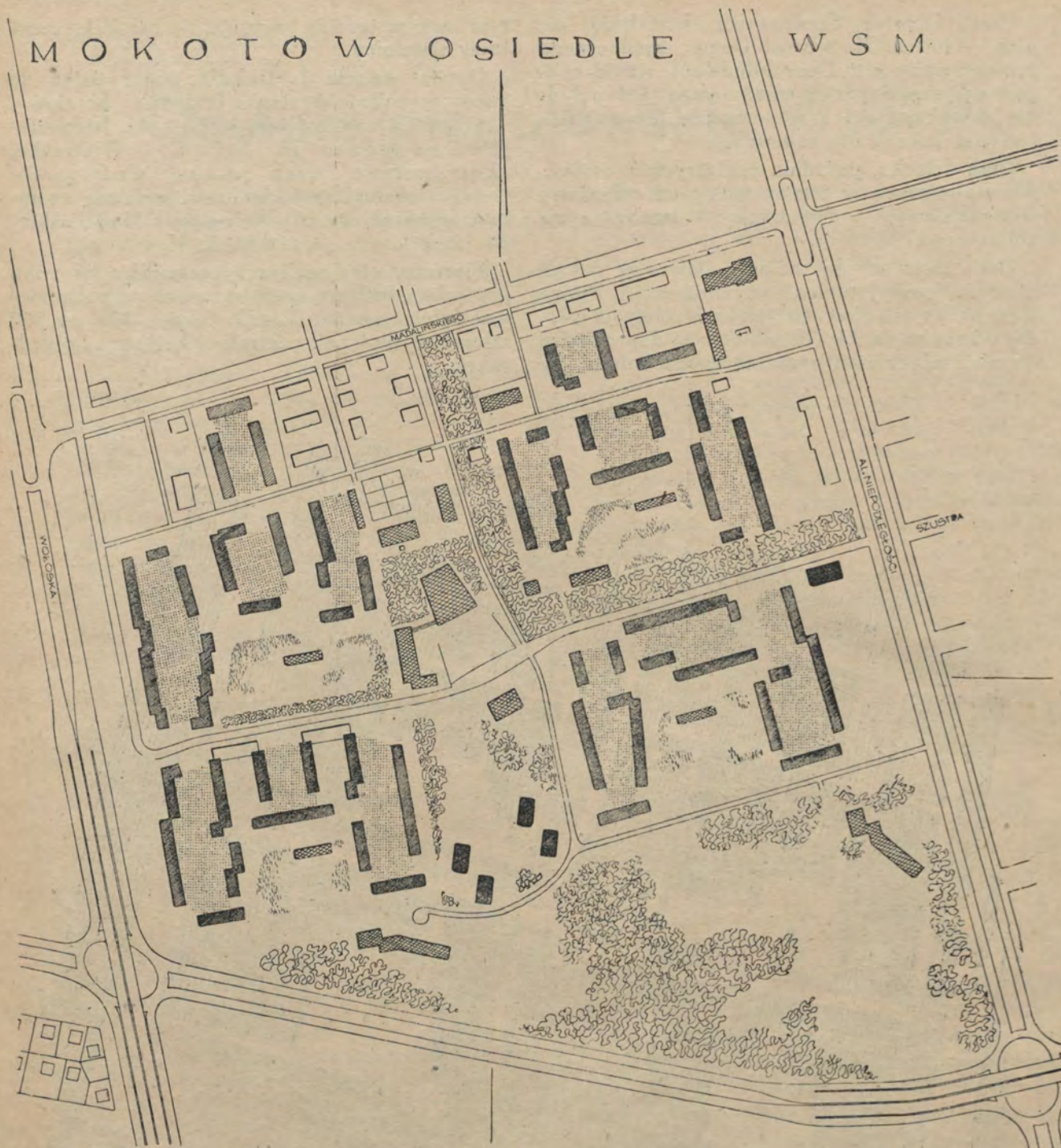
Osiedle W. S. M. na Mokotowie. — Podział terenów: M — mieszkaniowe obce, TM — mieszkaniowe W. S. M., G — przedszkoli, S — szkolne, DS — Domu Społecznego, DM — Domu Młodzieży, D — Domu Dziecka, G — gospodarcze, K — kotłowni, Z — zieleni, UP — budynków administracji publicznej
